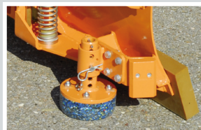
Höhenverstellbare Gleitpflanz-Garnitur Height-adjustable set of gliding devices Jeu de patins réglables en hauteur
