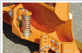
Schildflächen-Dämpfungsfeder Rake blade damping spring Ressort de compensation/absorption
