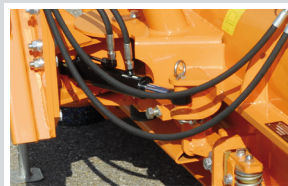
Hydraulische Seitenverstellung Hydraulic lateral adjustment Orientation latérale hydraulique
