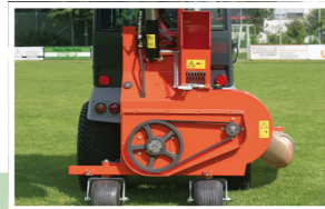
FAVORIT 650 H Neuer Riemenantrieb ohne Spannrolle New Belt drive without tension roller Entraînement par courroie sans poulie de tension
