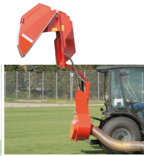
FAVORIT 650 H Hochentleerung bis 180 cm High dump up to 180 cm Vidage en hauteur jusqu'à 180 cm
