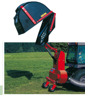
FAVORIT XP Hochentleerung bis 200 cm High dump up to 200 cm Vidage en hauteur jusqu'à 200 cm
